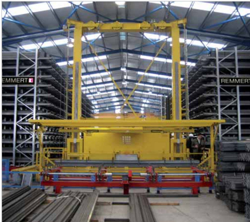
Wabenlager mit Regalbediengerät/Honeycomb storage with ASR unit
